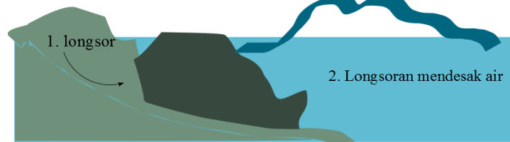
Gambar 4. Pembangkitan tsunami akibat longsor (Triatmadja, 2010).
