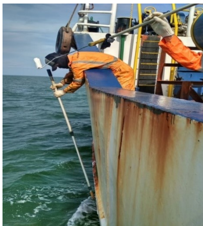
Gambar 5. Cat Rusak Dan Pudar
