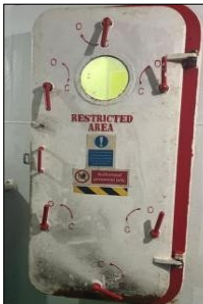
Gambar 1. Weathertight Door di MT Arimbi
