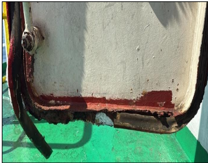
Gambar 3. Kerusakan Rubber Packing
